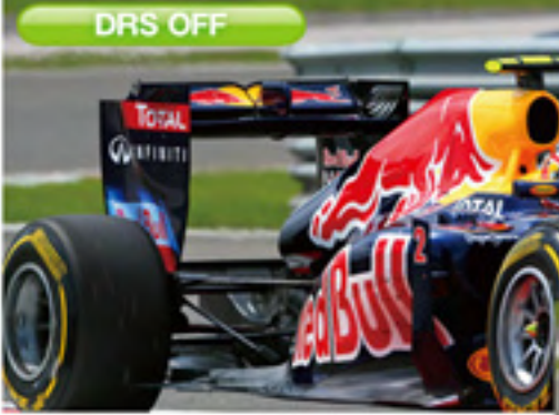
実車で見てみよう。コーナーなどダウンフォースが必要な場合は、ウイングのフラップは閉じたまま
