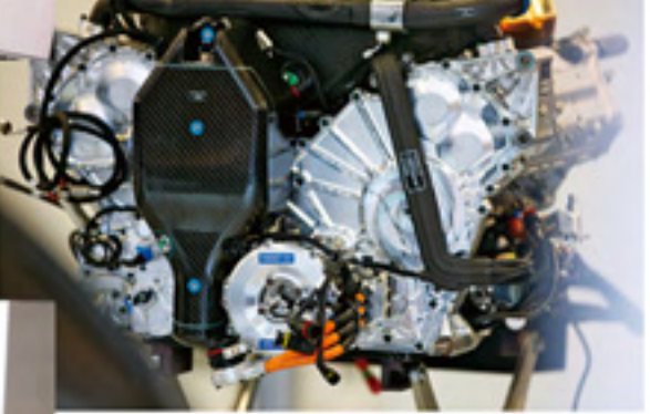
KERSのモーター(オレンジのホースが伸びる円筒形の物体)。減速時に発電機の役割を果たし発電し、必要ときに駆動力として放出
